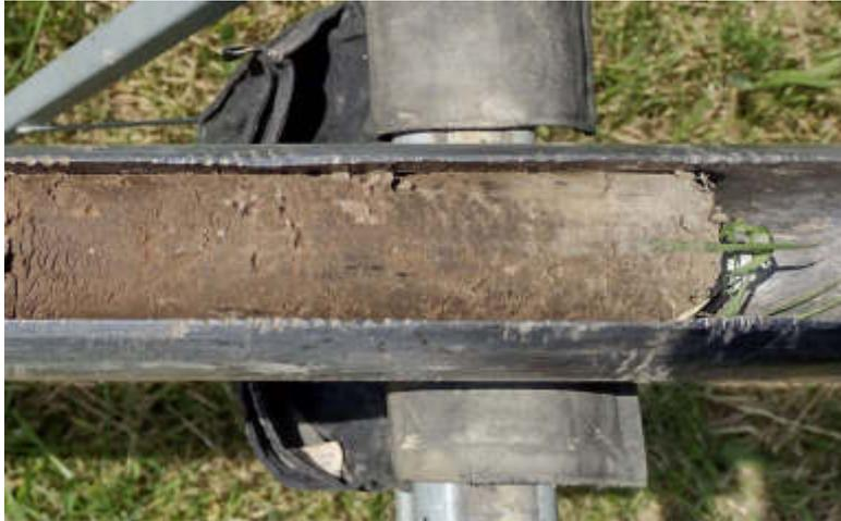
Foto Oberboden in Bohrsonde
