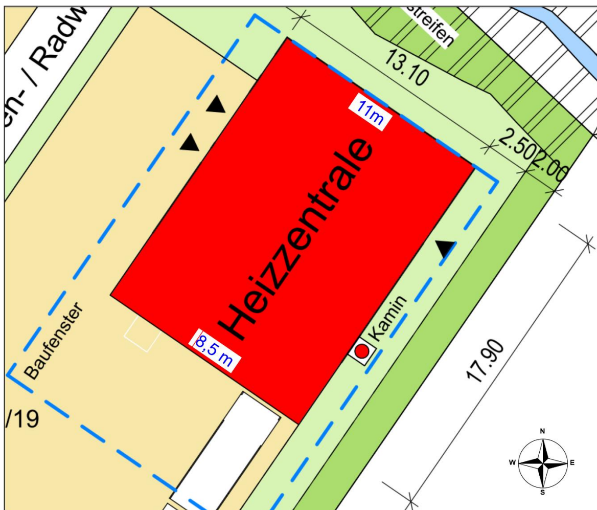
Abbildung 5-2: Trauf- und Firsthöhe der Nahwärmeversorgungsanlage. Die Firsthöhe wurde von 10,6 m auf 11 m gerundet.
